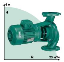
Условный проход: R 1 до DN 50 Перекачиваемая жидкость: вода и водогликолевая смесь для систем отопления, охлаждающая и холодная вода, техническая вода Температура жидкости: от –10 °C до +140 °C Рабочее давление: 6/10 бар до +120 °C 5/8 бар до +140 °C
