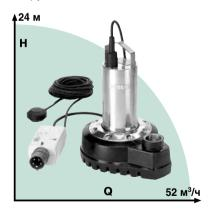
Условный проход:  $Rp\ 2$  до  $Rp\ 2^{1/2}$  Перекачиваемая жидкость: грязная вода Размер твердых частиц:  $max\ 10\ \text{мм}$  Температура жидкости:  $max\ 35\ ^{\circ}\text{C}$  Конструкция/Исполнение:
