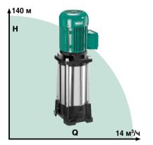
Условный проход: Rp 1 до Rp  $1^{1/2}$  Перекачиваемая жидкость: питьевая вода, вода для систем отопления, техническая вода, конденсат, водогликолевая смесь (до 40% содержания гликоля), другие маловязкие среды Температура жидкости: от  $-15~^{\circ}$ C до  $+90~^{\circ}$ C Рабочее давление: до  $16~^{\circ}$ бар Конструкция/Исполнение:
